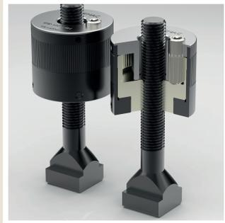
Sind die Werkstücke unterschiedlich groß, kommt die Serie ESD mit Durchgangsgewinde zum Einsatz. Eine Spannmutter ESD verfügt über ein integriertes Planetengetriebe, das durch eine kleine Mutter außerhalb des Gehäuses angetrieben wird. Dadurch wird
